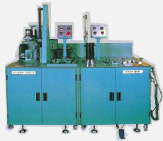
型枠脱型 掃除機
